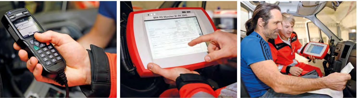
Mit Einführung des Digitalfunks im vergangenen Jahr hielten auch ein Ortungssystem und ein Thermodrucker im Fahrzeug Einzug. Die neue Technik vereinfacht das Protokollieren für die Einsatzkräfte und verbessert ihre Kommunikation mit der Rettungsleitstelle.
